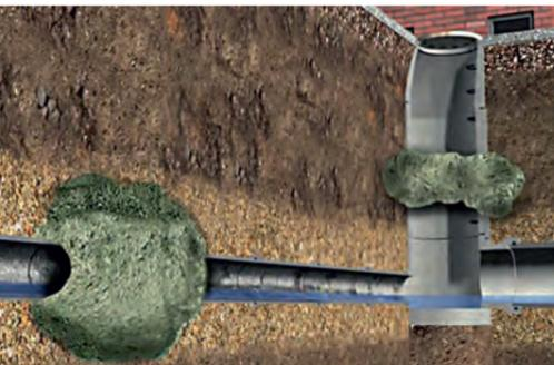
Flutungsverfahren: Dichtpackung aus Silikat außerhalb der Rohrleitung
