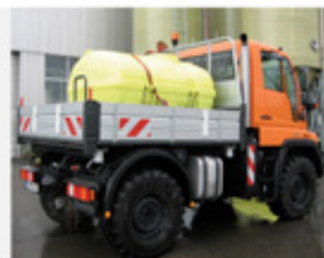
Schwallwände halten den Inhalt des Tanks auch bei heftigen Bewegungen im Zaum - für vielseitige Montage des Behälters auf ein Fahrzeug.
